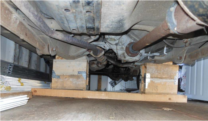
Houten blokken onder de voor-as van de auto
